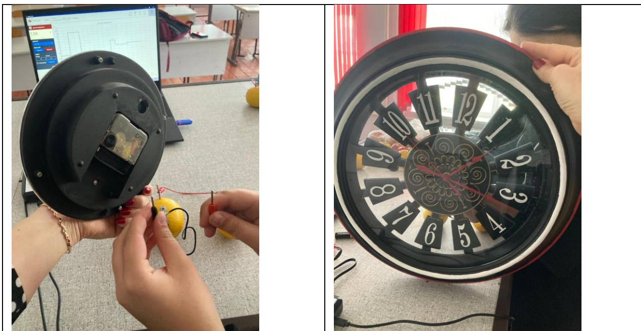
Рисунок 11 Попытка запитать настенные часы от фруктовой батарейки
